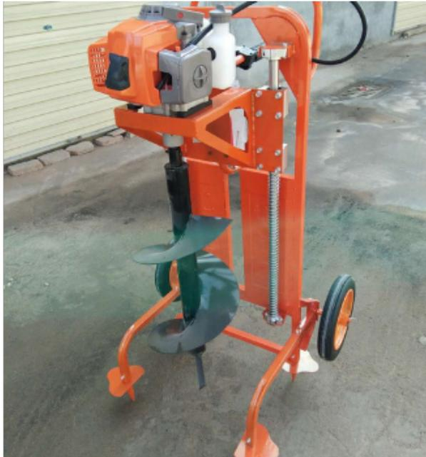
手提式挖坑机是由发动机气缸内装有活塞，活塞经过活塞销、连杆与曲轴相衔接。活塞在气缸内做往复运动，经过连杆推进曲轴转变。为了吸入新鲜气体和排出废气，设有进气门和排气门。活塞顶离曲轴中间远处，即活塞比较高方位，称为上止点。活塞顶部离曲轴中间近处，即活塞比较低方位，称为下止点。上、下止点间的间隔称为活塞行程，曲轴与连杆下端的衔接中间至曲轴中间的间隔称为曲轴半径。活塞每走一个行程相应于曲轴转角180度。关于气缸中间线经过曲轴中间线的发动机，活塞行程等于曲柄半径的两倍活塞从上止点到下止点所扫过的容积称为发动机的作业容积或发动机排量，用符号 $V_L$ 表明。四冲程发动机的作业循环包含四个活塞行程，既进气行程、紧缩行程、胀大行程(做功行程)和排气行程。折叠
